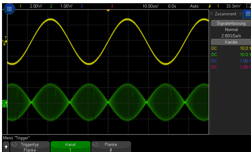
Abbildung 27 Amplitudenmodulation bei 40% Intensität
