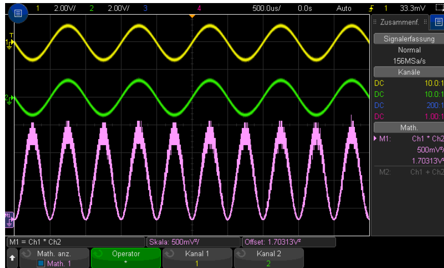
Abbildung 7 Beispiel: Multiplikation von Kanal 1 mit Kanal 2
