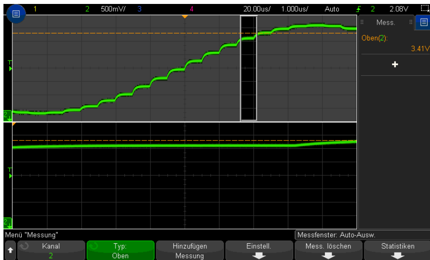
Abbildung 47 Isolationsbereich für Dachmessung („Top“)
