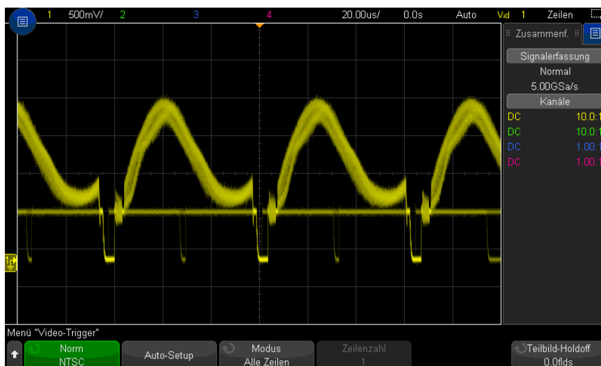
Abbildung 29 Triggerung auf alle Zeilen
